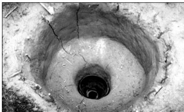
Рис. 6. Модель смолокурні на ходосівській експериментальній базі перед завантаженням сировини
