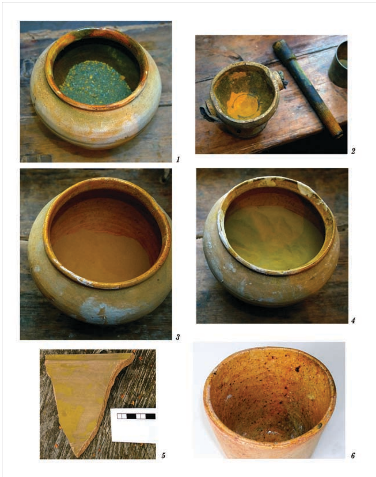
Рис. 12. Процес приготування поливи. 1 — перепалений свинець; 2 — ступка для подрібнення глини; 3 — просіяна глина; 4 — суміш просіяних свинцю і глини; 5 — черепок, посипаний сухою поливою; 6 — випалена полива
